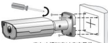
将自攻螺钉穿过底座导孔，用螺丝刀将其固定在墙壁
