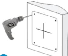
② 依照贴纸上标注的孔位钻出导孔
