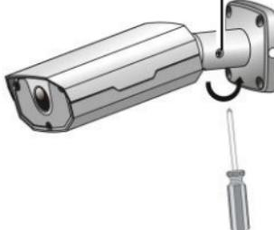
⑤ 安装设备上墙，连接所有电缆。
